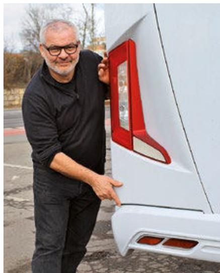
**„Für den sehr gut ausgestatteten Aufbau des C2-Tourer verwendet Carthago hochwertige Werkstoffe. Die Verarbeitung ist top. Doch der tief angesetzte, schmale Heckstoßfänger bietet wenig Schutz für die weit herunter reichenden Teile des Hecks.“**
