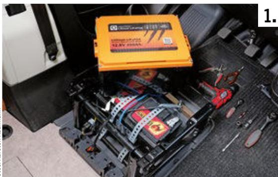
1. Energieplus im Anflug: Mit der 200er Liontron soll die 4-fache Energiemenge in den Vantourer 630L einziehen.
