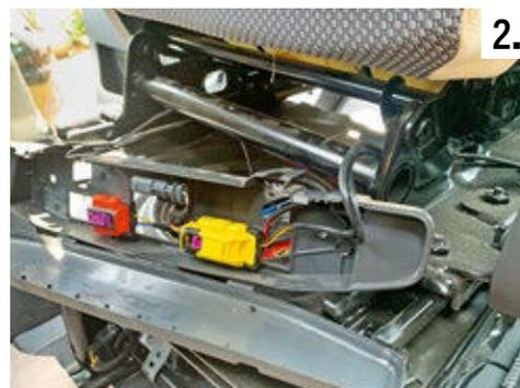
2. Elektronik: Stecker lösen. Jetzt können Sie das hinten am Sitz befindliche Fach abnehmen.
