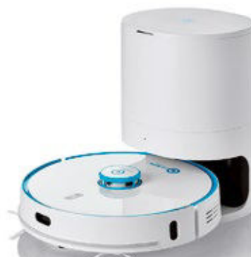
Der Adlatus SR1300 bewältigt Steigungen von bis zu 20 Prozent und kann seinen Abfallbehälter selbstständig entleeren. Die Saug-Wisch-Roboter Co-botic 45 und Co-botic 1700 von I-team sind als Partner einer menschlichen Putzkraft gedacht.
