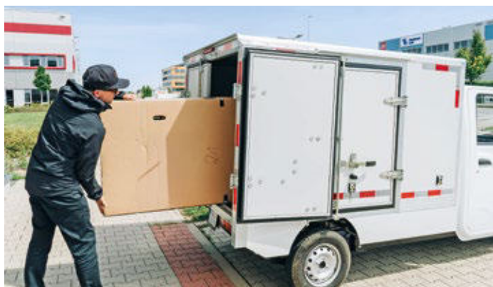
Mit 850 kg Nutzlast und einem Laderaumvolumen von 3,47 m 3 in der Standard-Koffervariante eignet er sich für unterschiedlichste Einsätze.
