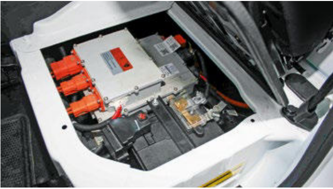
Serienmäßig werden beim ARI 458 Pro mit dem Standard LifePo4-Akku zwischen 120 und 180 Kilometer erreicht.
