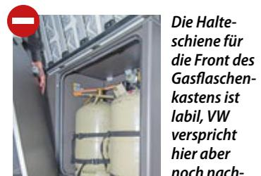
**-** Die Halteschiene für die Front des Gasflaschenkastens ist labil, VW verspricht hier aber noch nachzubessern.
