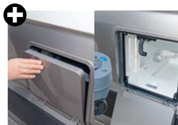
**+** WC-Klappe mit Zentralverriegelung und abgedichteter WC-Schacht.
