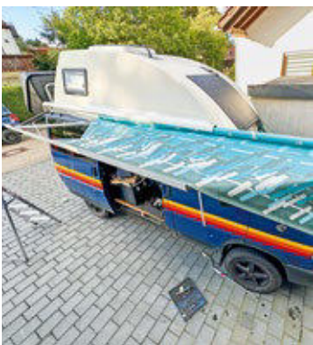
5. Nach vier, fünf Schrauben kann das Tuch samt Welle herausgezogen ...
