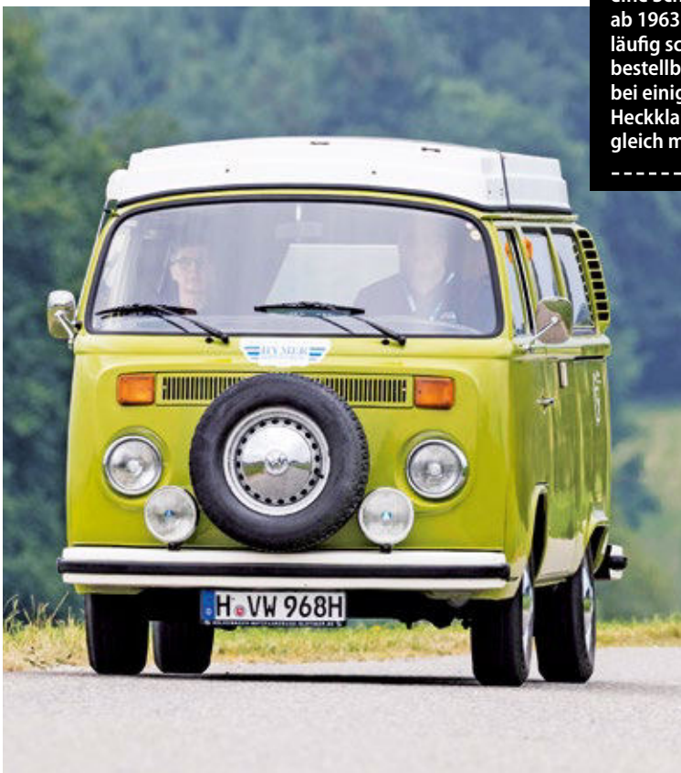
Im Heck dieses taigagrünen T2b boxert bereits der 70 PS starke 2,0-Liter. Das Facelift-Modell ist an den hochgesetzten Blinkern und an den eckigen Lufteinlässen leicht zu erkennen.
