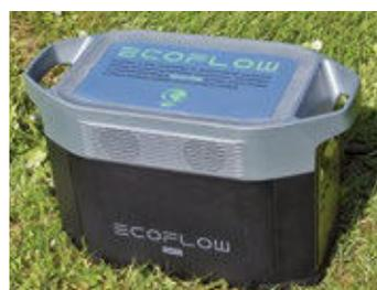
Mit einer Kapazität von 2.016 Wh und dem 2.400-W-Wechselrichter kann die recht kompakte Delta sparsame Geräte sehr lange mit Strom versorgen.
