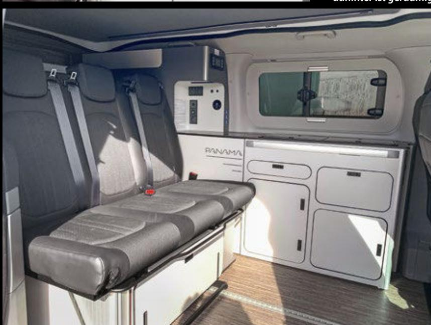
Die Einrichtung wirkt modern. Der Ausbau folgt dem bekannten Konzept mit fahrerseitigem Möbel, das allerdings aus robustem HPL gefertigt ist.
