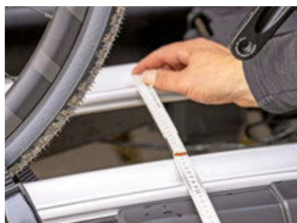
Der Schienenabstand bei Bikes mit Boost-Achsen sollte mindestens 25 cm betragen.
