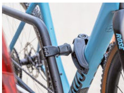
Der Schienenabstand bei Bikes mit Boost-Achsen sollte mindestens 25 cm betragen.
