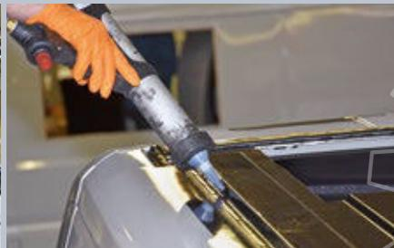
Auch beim Dachaufbau sind Profis am Werk, die jeden Handgriff kennen. 25 Tuben Sikaflex werden nach Plan auf der Dachfläche verteilt – das hält auf jeden Fall für immer.
