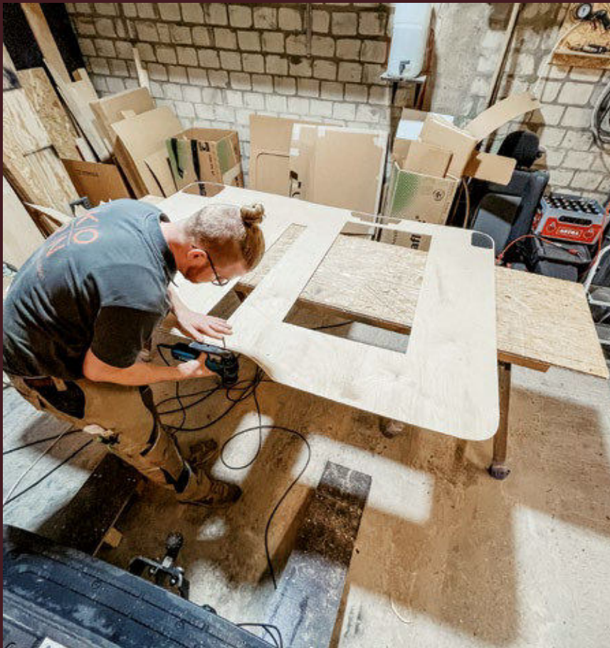
Der Fußboden: 11 mm dicke Multiplexleisten wurden auf die Karosserie geklebt und zum Trocknen fixiert, der Boden mit 9 mm Armaflex isoliert, die alte Bodenplatte wieder eingebaut und Vinylböden darauf verlegt. Unten: Die Verkleidung der Schiebetür wird aus 4 mm starkem Birke-Multiplex gefertigt und anschließend mit Filz bezogen. Im unteren Teil der Schiebetür wurde auf Isolierung verzichtet, damit Kondenswasser abtropfen kann.
