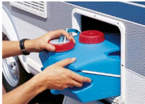
**GEPUTZT** Clevere Tankinstallationen, wie bei Knaus, machen es einfach, den Tank und alle Zu- und Ableitungen gut zu reinigen. Ein Rolltank statt des festen Tanks erleichtert die Reinigung des Wasserbehälters aber noch ein wenig mehr.
