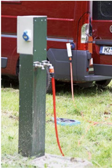
**GEKLEMMT** Der Wasserdieb von Gardena erlaubt am ein oder anderen Wasserhahn doch einen Anschluss für den Schlauch zu bewerkstelligen, wenn das Gewinde nicht passt oder gleich gar keines vorhanden ist.
