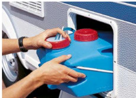
**GEPUTZT** Clevere Tankinstallationen, wie bei Knaus, machen es einfach, den Tank und alle Zu- und Ableitungen gut zu reinigen. Ein Rolltank statt des festen Tanks erleichtert die Reinigung des Wasserbehälters aber noch ein wenig mehr.
