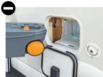
Geht besser: Der Schacht der Kassettoilette ist nicht abgedichtet.
